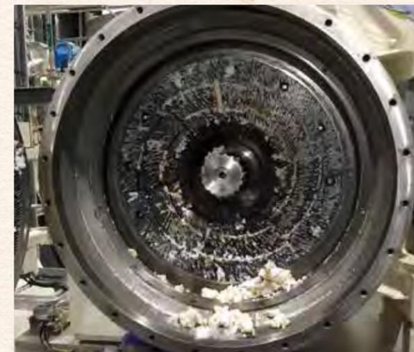
Holzerkleinerung mit dem Refiner-Verfahren
