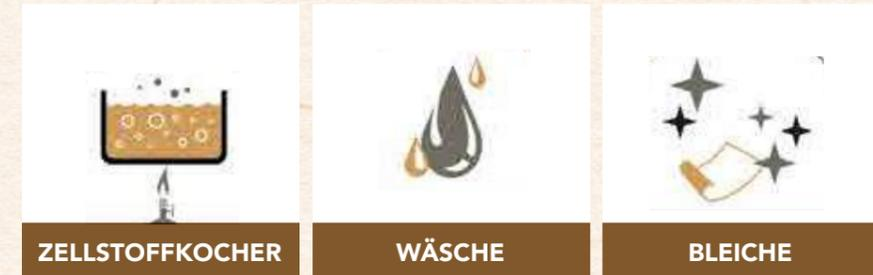
Für diese chemische Aufbereitung wurden verschiedene Verfahren entwickelt. Welche Verfahren eingesetzt werden, hängt von den verwendeten Holzarten und den gewünschten Endprodukten ab. Die häufigste Methode, Zellstoff herzustellen, ist das sogenannte „Sulfatkochverfahren“ („Sulfate“ haben immer etwas mit Schwefel zu tun). Mit diesem Verfahren werden 95 % des weltweit erzeugten Zellstoffs produziert. Bei dieser Art der Zellstoffproduktion werden die Hackschnitzel
