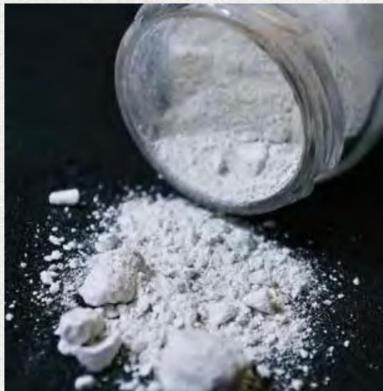
Kaolin – ein Füllstoff für die Papiererzeugung
