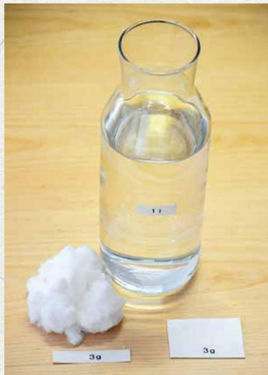
Wasser und Zellstoff (Flocken oder gepresst) im Mengenverhältnis der Fasersuspension
