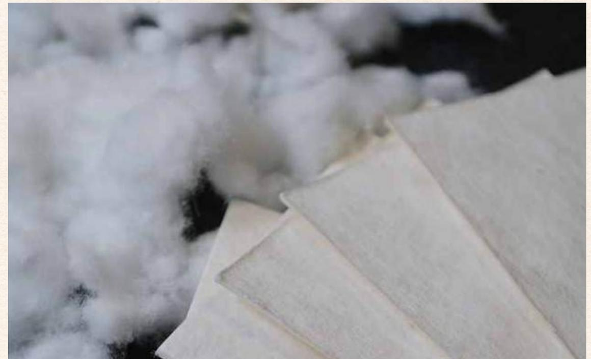
Zellstoff, lose (Flocken) und gepresst
