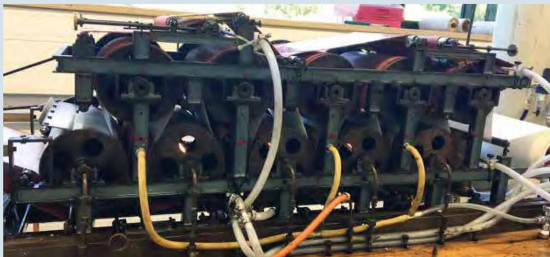
Papiermaschinen in Papierfabriken geben meist wenig Einblick in die Produktionsvorgänge. Aber an der Technischen Universität Graz (Institut für Papier-, Zellstoff- und Fasertechnik) steht eine Miniaturpapiermaschine, die echtes Papier herstellt. Zu speziellen Anlässen wird die Maschine in Betrieb genommen (am Bild siehst du die Trockenpartie). Hier können auch Kinder die Abläufe gut nachvollziehen.
